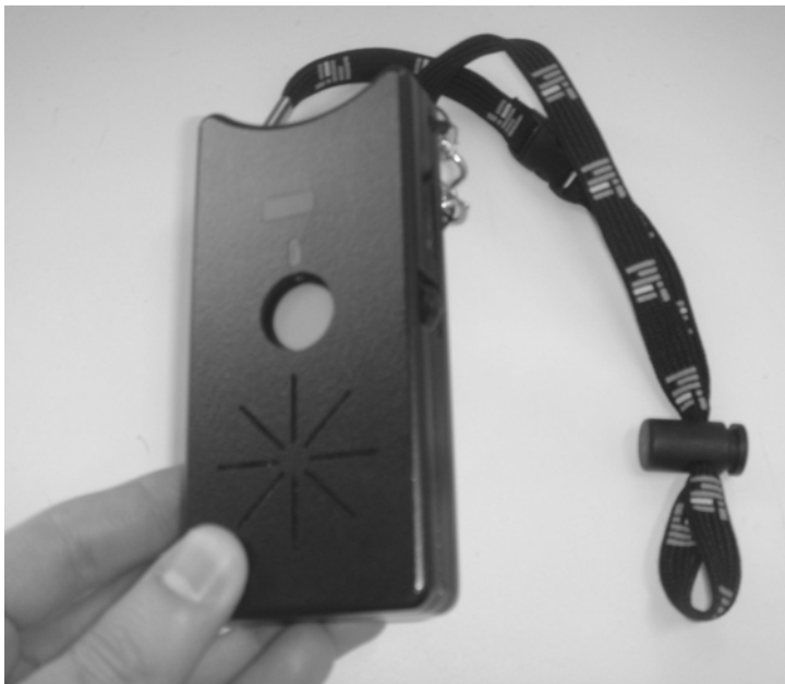
Abbildung 2: Tragbarer Sensor (Social Badge) zur Erfassung von persönlicher Kommunikation
